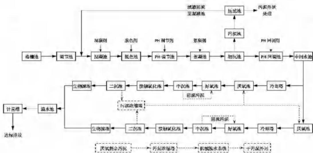
图 2.5.1-1 废水处理工艺流程图
